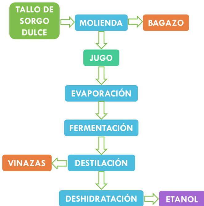
Figura 1. Diagrama de proceso para la producción convencional de etanol de sorgo dulce.
