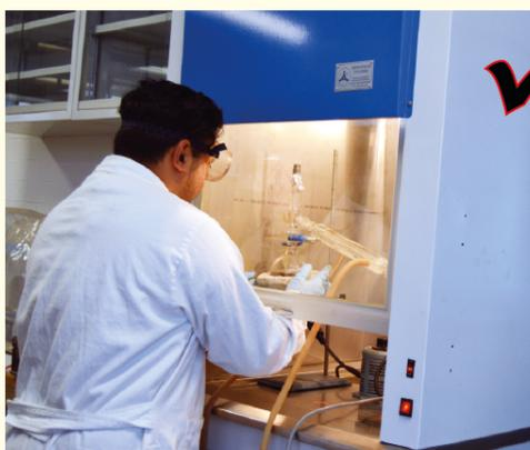
Los experimentos que involucren manejo o producción de vapores o gases tóxicos, polvos, la apertura de recipientes con sustancias volátiles, o riesgos de salpicarse, ignición o explosiones pequeñas, deben llevarse a cabo en campanas de extracción.
