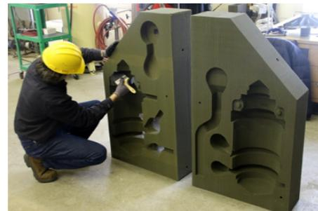
Figura 5. La arena sílicea se utiliza para la producción de moldes de fundición.
