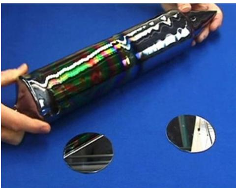
Figura 1. Lingote final de silicio y obleas una vez cortadas.
