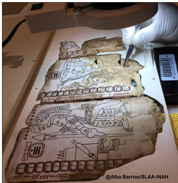
Figura 2. Toma de muestras del folio 9 del CMM con ayuda de un microscopio estereoscópico.
