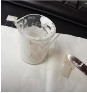
Imagen 7. Fijar pasta TiO sobre vidrio.
