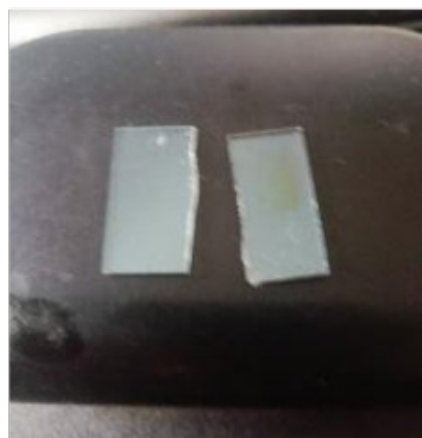
Imagen 6. Cortar del vidrio ITO.
