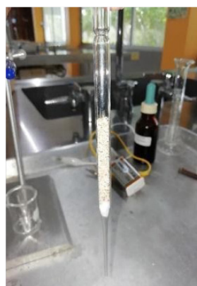
Imagen 13. Construir el filtro de arena.
