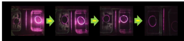
Figura 5. Efecto de la temperatura en la rapidez e intensidad de reacción quimioluminiscente de las barras luminosas al transcurrir el tiempo.
