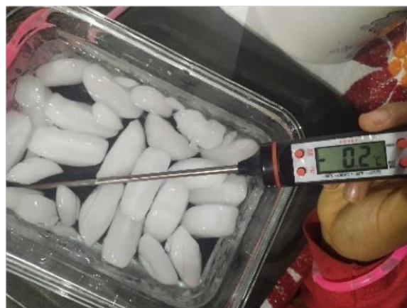
Figura 3. A) Temperatura del agua helada, -0.2 °C
