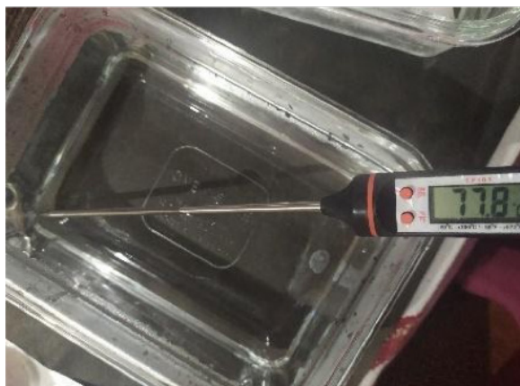
Figura 3. B) Temperatura del agua caliente, 77.8 °C.
