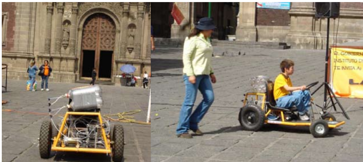
Foto 2. Prototipo Go-kart híbrido con hidrógeno/oxígeno del aire y celdas de combustible, diseñado y construido por la estudiante de doctorado Karina Suárez Alcántara en 2007, para difundir el uso de la electrocatálisis en la energética electroquímica.
