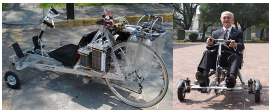
Foto 3. Tecnología del hidrógeno y celdas de combustible en una bicicleta monoplaza, Nayaa , construida por el grupo de energética electroquímica del Cinvestav y avalado por Mario Molina, premio Nobel de Química 1995.
