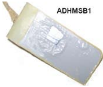
Fotografía 3. Zonas de ampollamiento sobre la película despegada al final de la prueba REAP sobre la pintura con el pigmento B en condiciones de daño.
