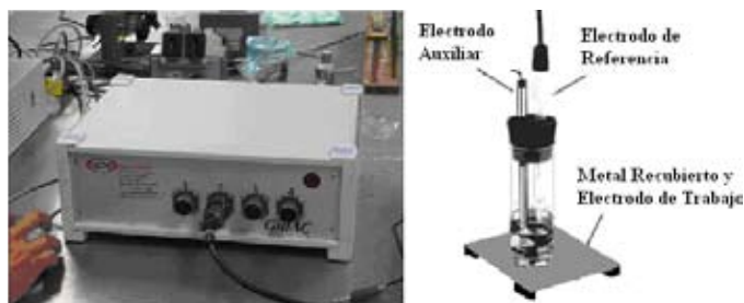
Fig. 1. Instrumentación y celda electroquímica utilizada.
