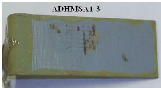
Fotografía 1. Zonas de ampollamiento sobre la película despegada al final de la prueba PEDR de la pintura con el pigmento A en condiciones de daño artificial.
