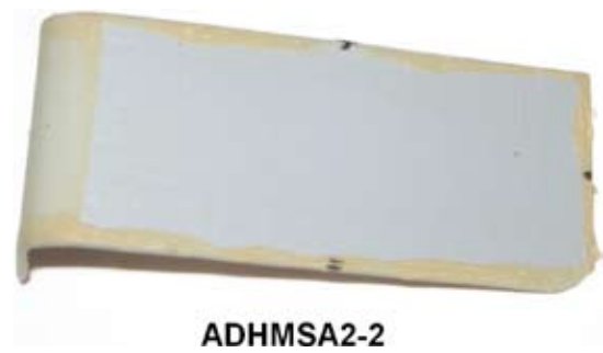
Fotografía 2. No se produjo ampollamiento después de la prueba REAP sobre el recubrimiento de la pintura con el pigmento A en condiciones intactas.
