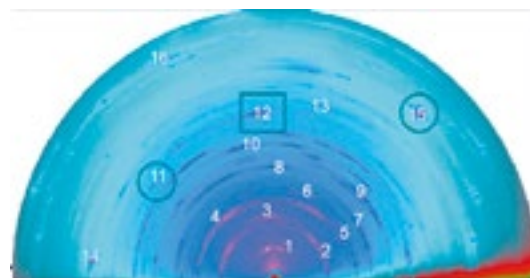
Figura 7. Patrón bidimensional de difracción de rayos X con incidencia rasante de 2^\circ de la muestra SWESH01, obtenido en el Stanford Synchrotron Radiation Lightsource (SSRL), Beamline 11-3. Se muestra la identificación de las reflexiones de yeso y de las impurezas esfalerita (12) y hematita (11 y 15).
