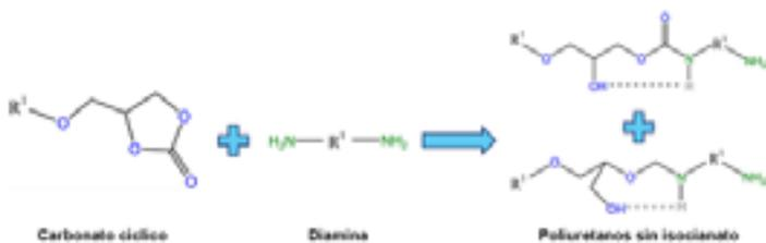
**Figura 4.** Síntesis de poliuretanos sin isocianatos (NIPU) vía adición de diaminas con carbonatos cíclicos. **Fuente:** elaboración propia.
